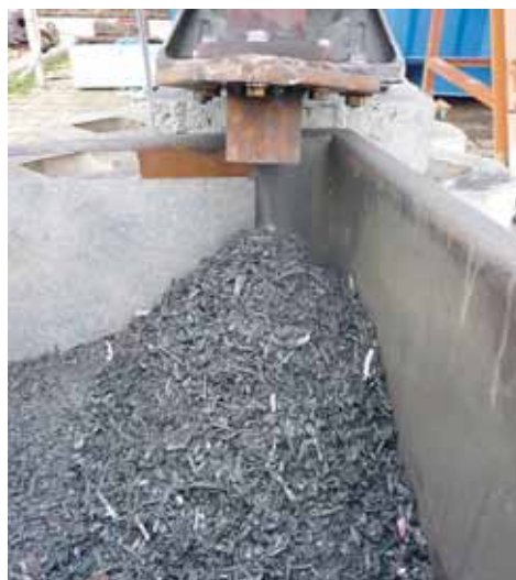
Auffangbecken der Biokohle. Die Delinat-Anlage wird ab Juli 3 Tonnen Biokohle pro Tag herstellen
